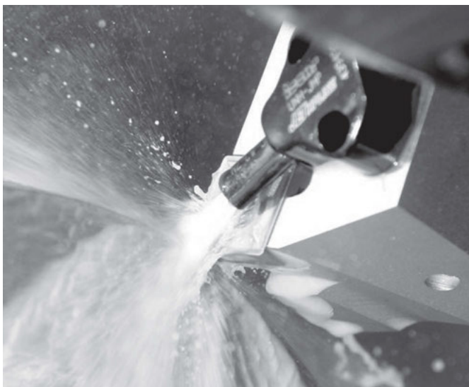
KSS-Einsatz unter Hochdruck hilft Effizienz und Prozesssicherheit zu erhöhen.
